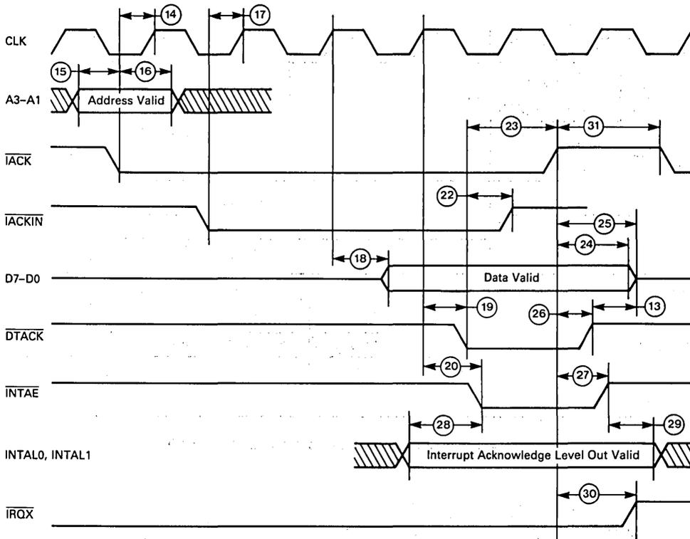
FIGURE 10 — INTERRUPT ACKNOWLEDGE CYCLE — INTERNAL VECTOR
