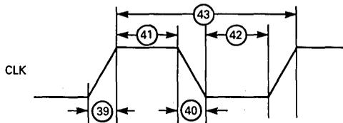
FIGURE 14 — CLOCK WAVEFORM
