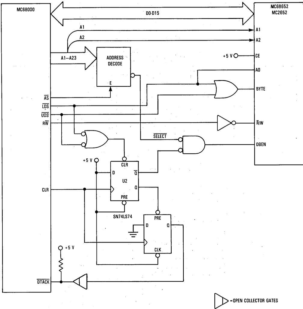
Figure 21. MC68000/MC68652 Interface Circuit
