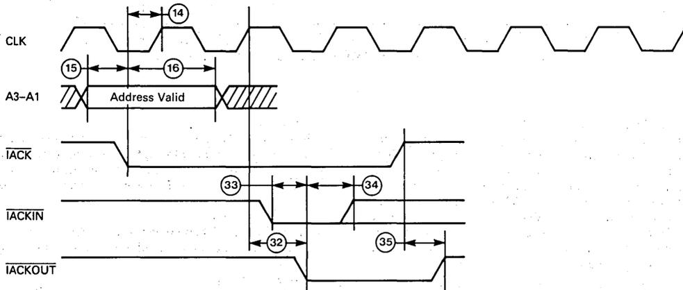
FIGURE 12 — INTERRUPT ACKNOWLEDGE CYCLE — IACKOUT
