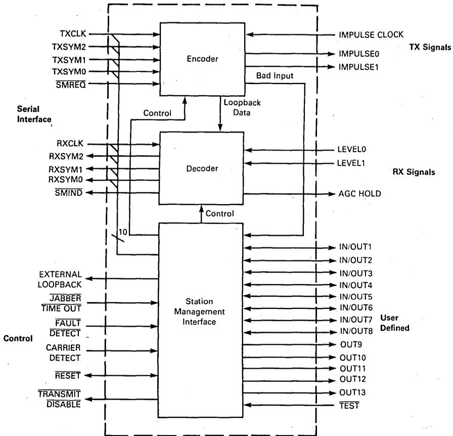
FIGURE 1-3 — FUNCTIONAL BLOCK DIAGRAM FOR BROADBAND INTERFACE CONTROLLER
