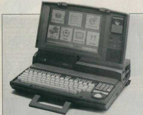
**Fast wie die PC-Laptops nicht "Stacy", der ST mit Griff, aus. Besonderheit ist der integrierte Trackball, der die Maus ersetzen soll.**
