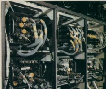
Fünf mit Lichtleitern verbundene Hochleistungsrechner sind das Herz von ATTAS. Dank solcher Rechenleistung kann ATTAS andere Flugzeuge simulieren und auf die Befehle des Piloten beispielsweise wie ein Airbus reagieren.
