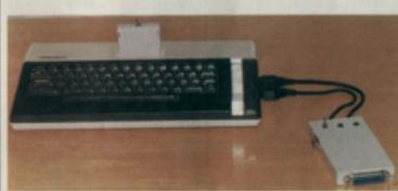
Mit der Steuer-Software im Stockmodul kann man auf das Diskettenlaufwerk verzichten
