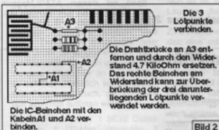
Die Drahtbrücke an A3 befindet sich auf der Unterseite der Platine. Ich habe einfach die Brücke durchgeschnitten und den Widerstand 4,7 KOhm eingelötet. Danach hatte ich die drei Lötpunkte (siehe Zeichnung - rechts neben A3) miteinander verbunden.
