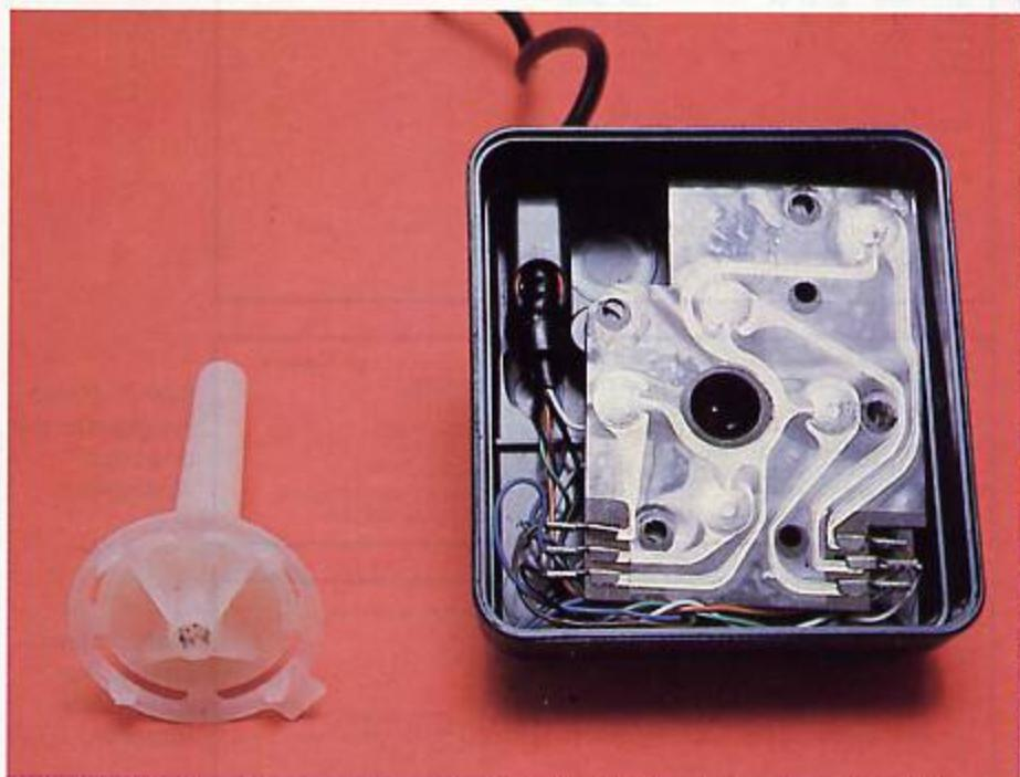
**Bild 2. Atari-Joystick von innen: Rechts die Platine, links der eigentliche Steuerknüppel**
