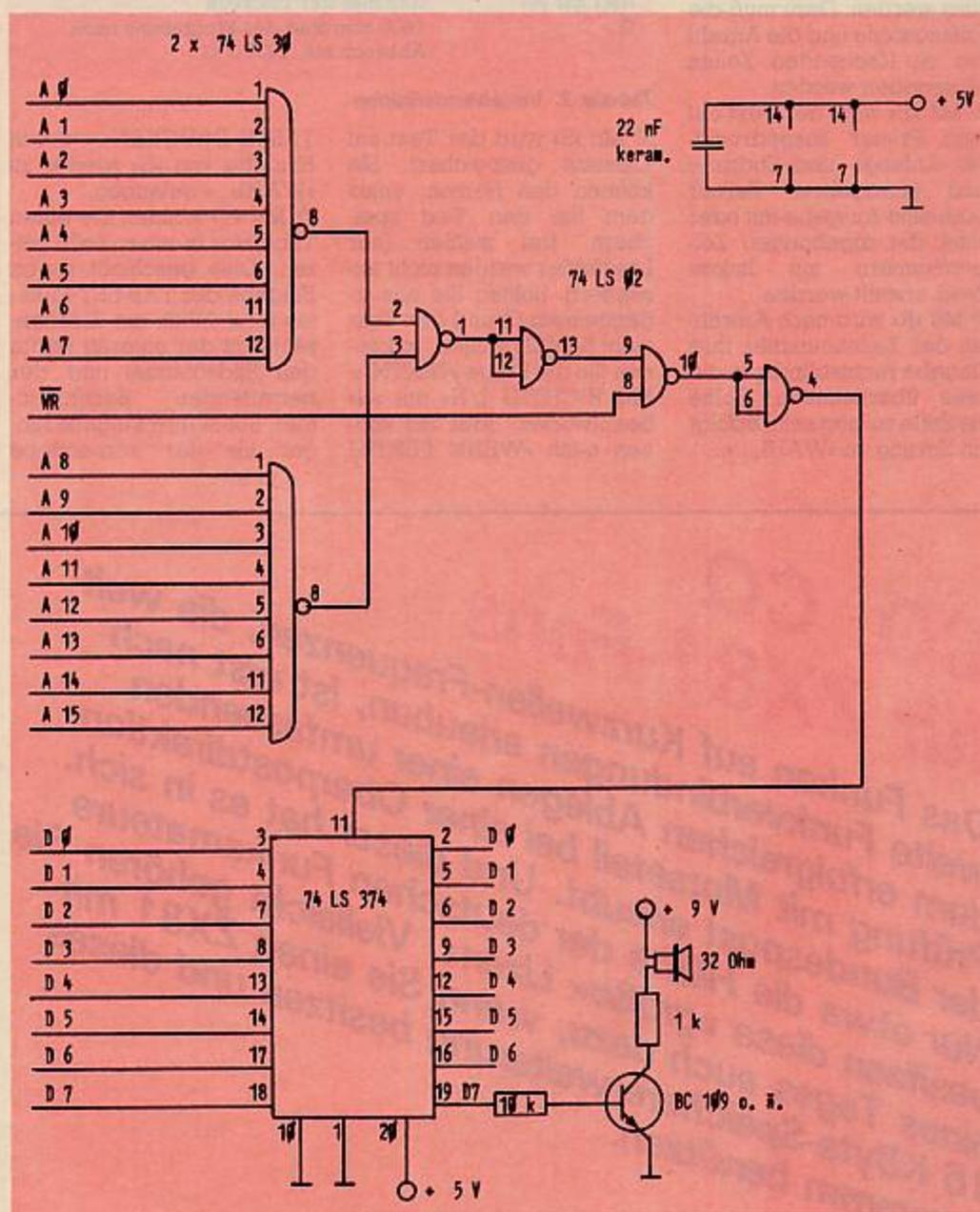
Bild 2. Decodierung der Speicherzelle 65535 und Ansteuerung eines Lautsprechers
