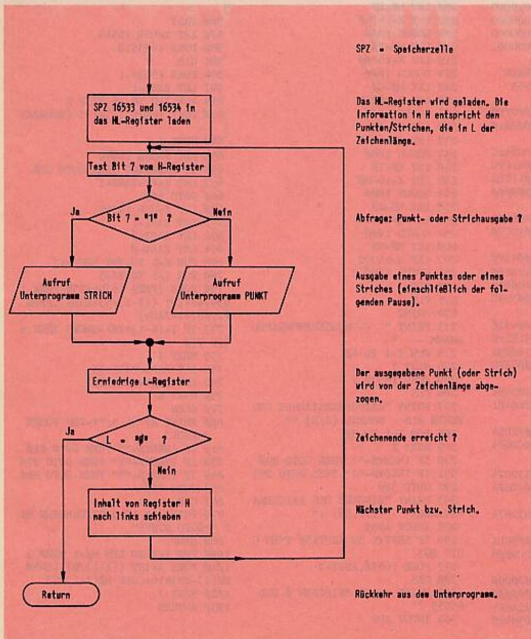
Bild 3. Ablaufplan des Unterprogramms zur Erzeugung von Morsezeichen
