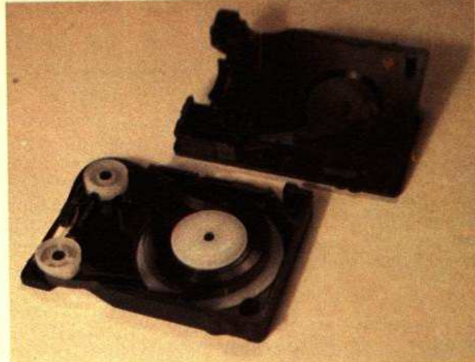
Bild 7. Der innere Aufbau einer Kassette
