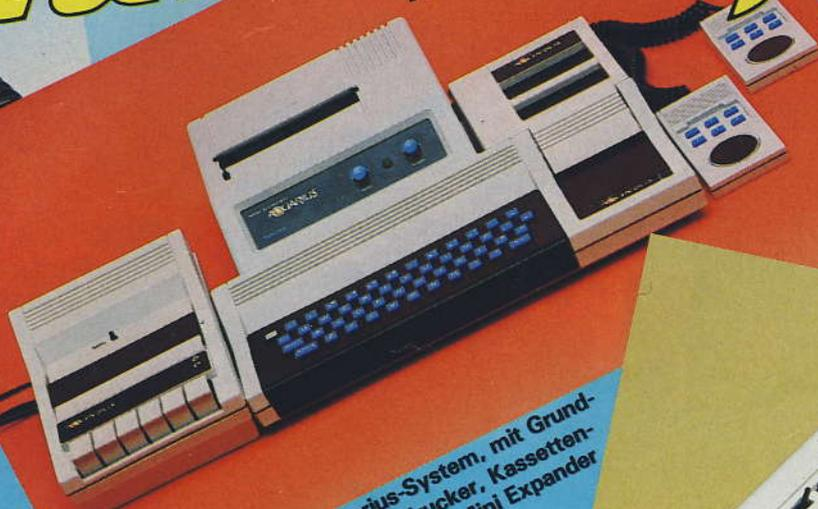
Bild 1. Das komplette Aquarius-System, mit Grundgerät, Thermodrucker, Kassettenrecorder und Mini Expander
