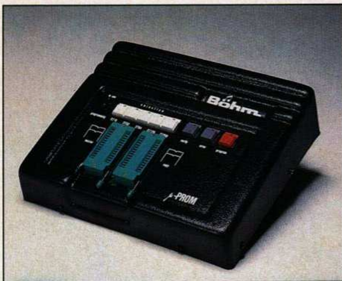
Das fertig aufgebaute EPROM-Programmiergerät
