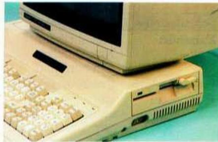
**An der Seite befindet sich das integrierte 5¼-Zoll-Disklaufwerk**
