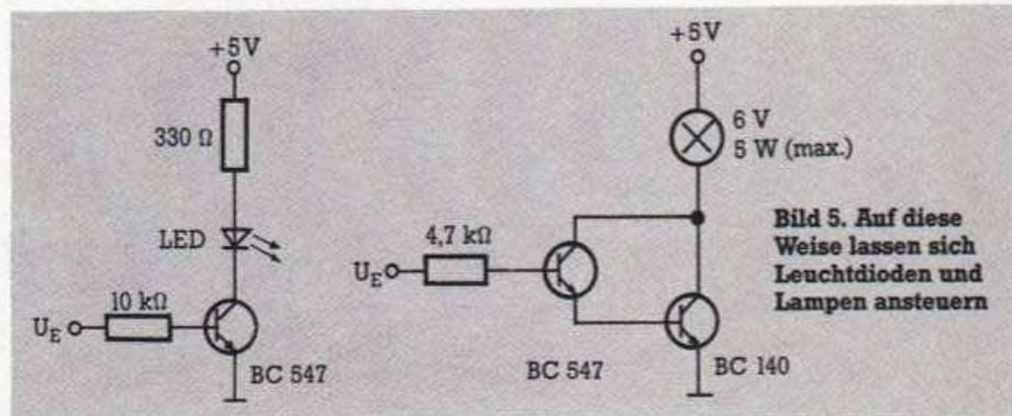
**Bild 5. Auf diese Weise lassen sich Leuchtdioden und Lampen ansteuern**
