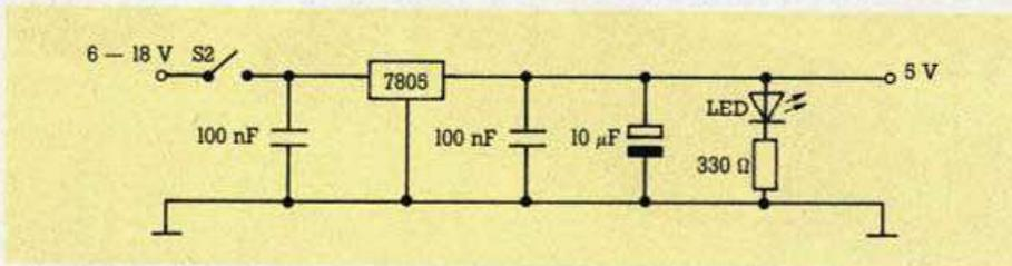
**Bild 5. Diese Schaltung regelt die Eingangsspannung auf 5 Volt herunter**
