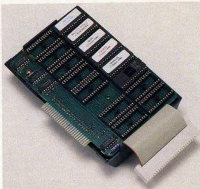
**Bild 2. Die voll bestückte »PhiloSoft«-Platine mit RS232-Interface, EPROM-Brenner und Software-ROM muß ohne Gehäuse auskommen.**
