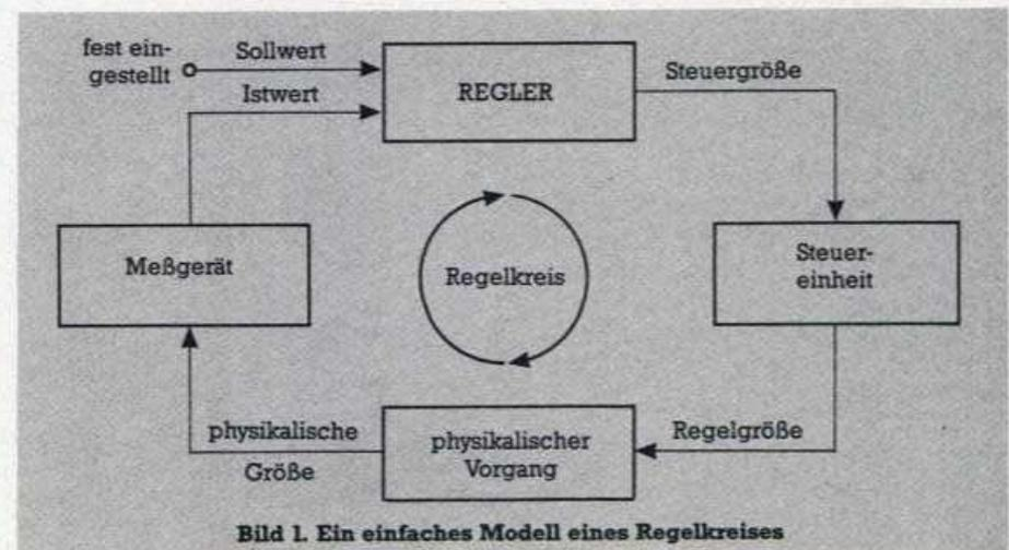
Bild 1. Ein einfaches Modell eines Regelkreises
