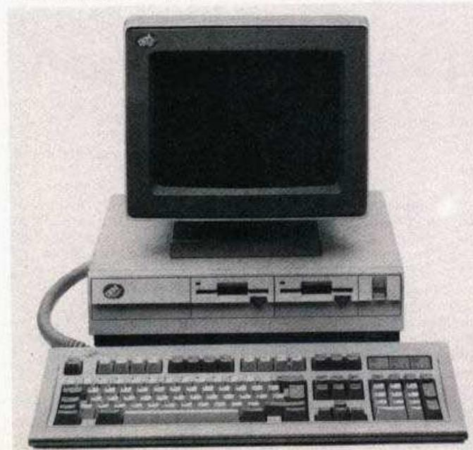
Das Modell 30 mit zwei Diskettenlaufwerken, Tastatur und Monitor
