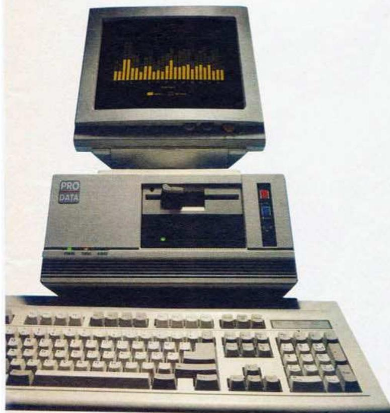
**48** Die Computerpreise fallen. Sogar ATs, die MS-DOS-Computer von der schnellen Sorte, gibt es jetzt schon für weniger als 3000 Mark, ausgestattet mit 80286-Prozessor, 512 KByte RAM, Hercules-Grafik-Karte, Monochrom-Monitor, Diskettenlaufwerk (1,2 MByte), 20-MByte-Festplatte, Tastatur, Betriebssystem MS-DOS und Handbüchern.
