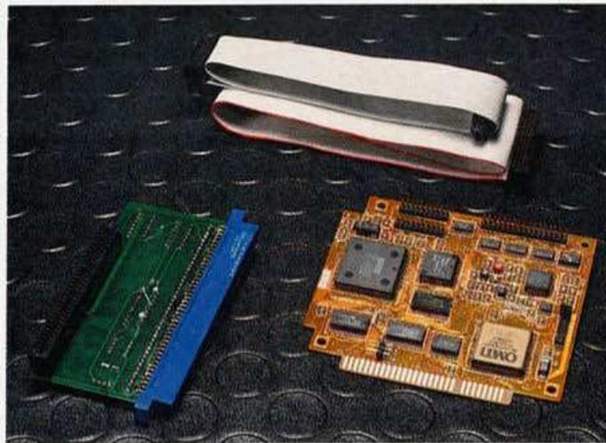
**Festplatte für Individualisten: Bei A.L.F. wird kein Festplattenlaufwerk mitgeliefert. Dafür läßt sich jede Festplatte mit ST-506-Interface anschließen. Mit 20-MByte-Platte kommt man mit A.L.F. am günstigsten an eine Amiga-Festplatte.**
