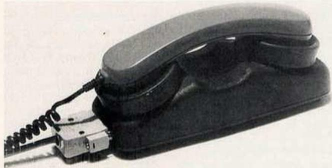
Nach dem Wählen wird der Telefonhörer in die Muscheln des Akustikkopplers hineingeklemmt
