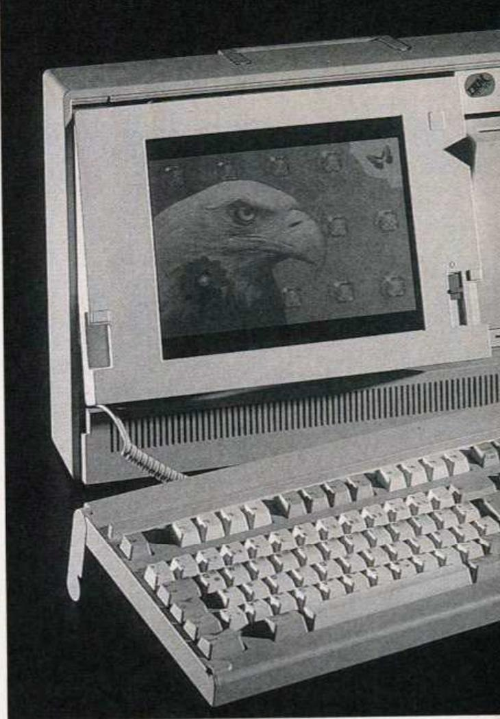
In dem aktenkoffergroßen Modell steckt alles, was einen Super-AT ausmacht: schneller 386-Prozessor mit 20 MHz Taktrate, hochauflösendes VGA-Plasma-Display plus entsprechender Grafikkarte, 60-MByte-Festplatte, 3½-Zoll-Laufwerk und eine vollwertige breite AT-Tastatur vom Typ MF-II (102 Tasten). Schnittstellen für Drucker, Maus, Modem und externen Monitor oder 5¼-Zoll-Laufwerk sind selbst-
