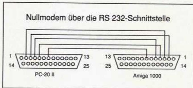
Für das Nullmodem verbinden Sie jeweils Pin 2 und 3 sowie Pin 4 und 5 über Kreuz, Pin 7 ist Masse
