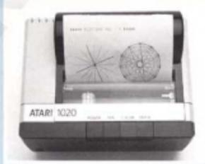
Tout a été prévu pour une parfaite sécurité de fonctionnement : dès sa mise sous tension, l'imprimante dessine 4 carrés avec chacun des crayons, pour vérifier leur bonne marche.
