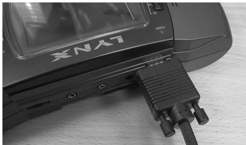
Wyjście VGA z Atari Lynx.
