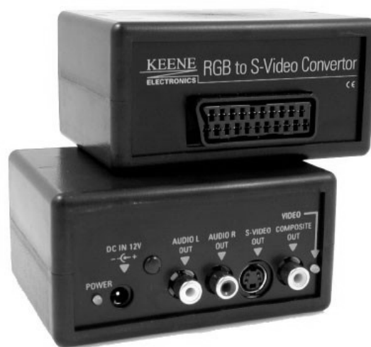
Konwerter sygnału RGB do S-Video.
