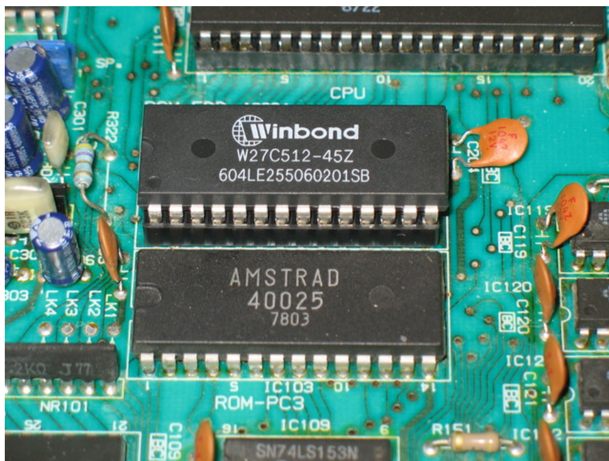
Dwa układy ROM na płycie głównej komputera.
