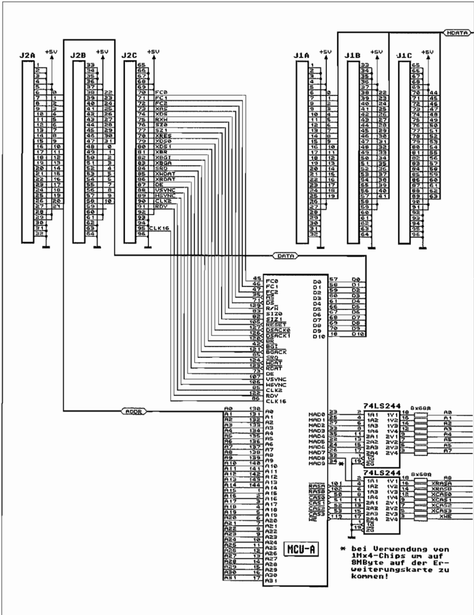
Abb. 3.2: Aufbau der ST-RAM-Erweiterungskarte (linker Teil)
